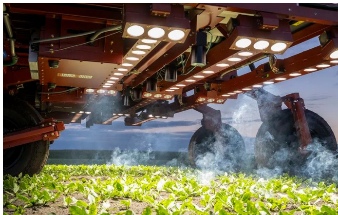
In foto: l'impianto LaserWeeder di Carbon Robotics; grazie all'IA il sistema è in grado di utilizzare l'energia termica per eliminare le erbacce senza danneggiare le colture sane o modificare eccessivamente il terreno.
