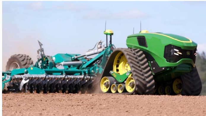
In foto: il progetto di trattore autonomo di John Deere. Il trattore a guida autonoma avrà una potenza di 500 kilowatt e sarà a zero emissioni.
