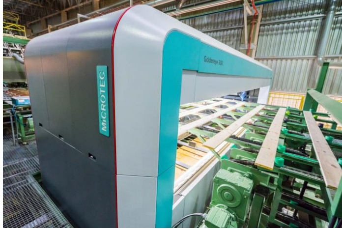
In foto: GoldenEye 900 di MiCROTEC, uno scanner trasversale che determina in maniera precisa la qualità del legname (sia esso fresco, essiccato o piallato) in un solo passaggio da tutti e quattro i lati.
